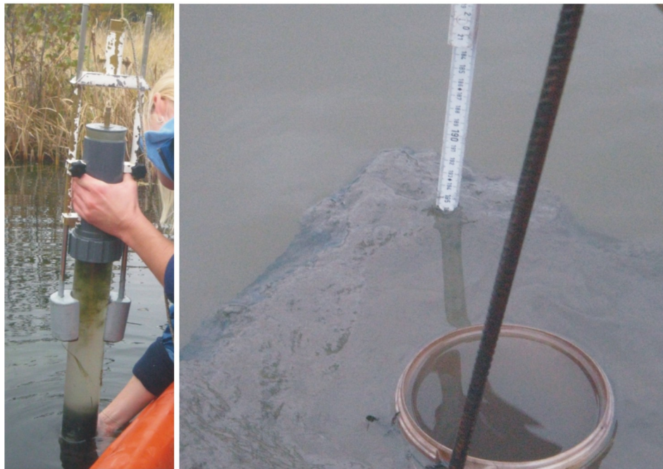
Figur 40. Sediment från dagvattendammar. Till vänster sediment i en rörhäm-tare av Willnertyp och till höger sediment på en så kallad NOS-fälla (Andersson m.fl. 2012).
