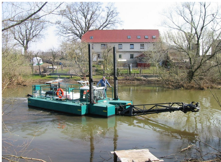
Figur 44. Exempel på en sugmuddringsbåt med skärmunstycke. Foto tms-engineering.nl
