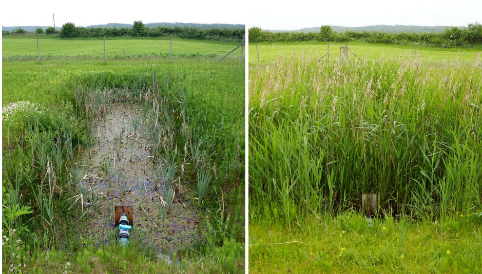
Figur 1. I experimentvåtmarkerna i Plönninge undersöktes hur olika vegetation påverkar reningseffekten. Bilden till vänster visar en damm som är bevuxen huvudsakligen med undervattensväxter och bilden till höger en damm som är bevuxen med övervattensväxter (bladvass).
