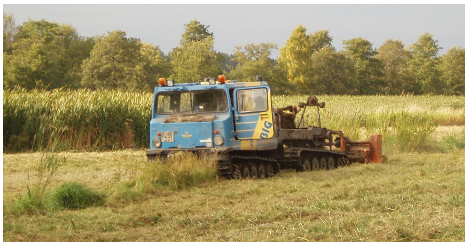
Figur 25. Slåtter av blöt översilningsyta med bandvagn, Trosa våtmark.
