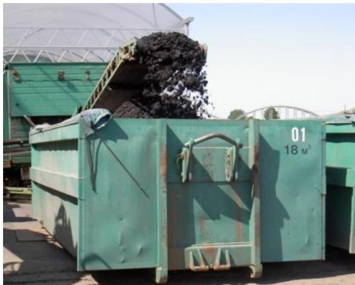
Figur 49. Sedimentkakor kastas ur en silbandspress för bortkörning med lastbil. Foto www.kurstjens.nl .
